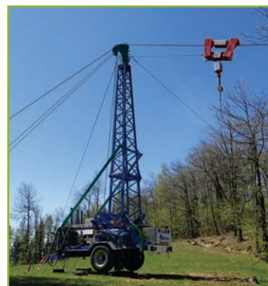
Gru a cavo con stazione mobile
