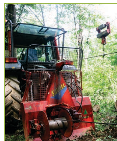
Mini-teleferica: argano a doppio tamburo portato da un trattore
